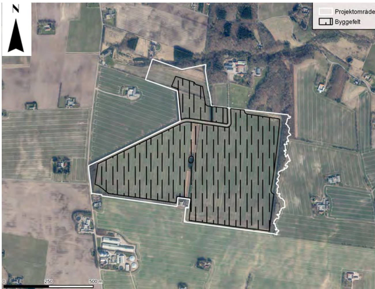
Figur 5-4 Byggefeltet til solceller og solcelleanlæggets øvrige bygninger er vist med skravering. Planområdets afgrænsning er vist med hvid streg.
